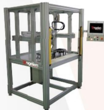
Sistemi di incollaggio a 3 assi serie GS senza sistema di visione
