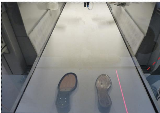
Il carico/scarico dei pezzi è reso agevole e produttivo mediante un nastro trasportatore che porta le suole nella zona di acquisizione, nella zona incollaggio e nella zona di scarico. La linea è completata da un forno essiccatore (opzionale).
