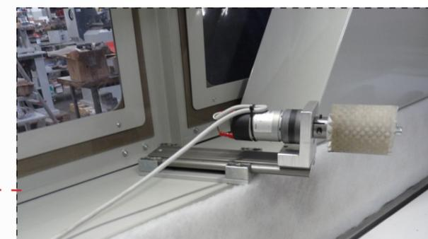
Sistema di pulizia ugello mediante spazzola rotante, è possibile programmare dopo quanti cicli di lavoro eseguire la pulizia.
