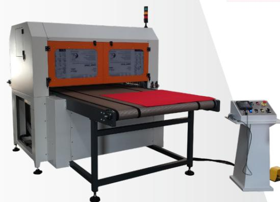
Incollatrice automatica spray con nastro di introduzione
